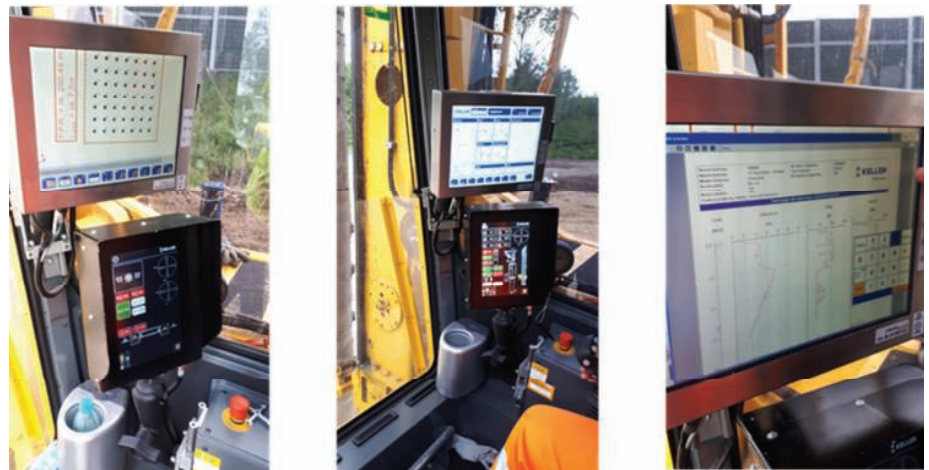
2. Widok systemu kontroli jakości i rejestracji danych wraz z panelem kontroli produkcji w kabinie operatora [4]
