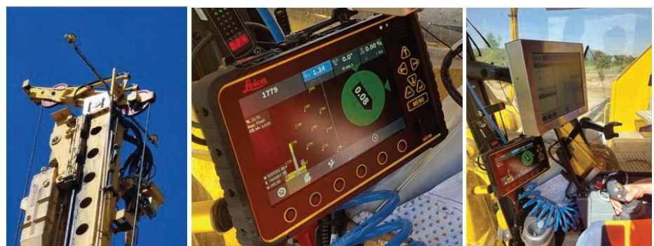
6. Maszyna wyposażona w system pozycjonowania GPS [4]
